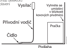
Obrázek 2 Montáž detektoru zaplavení
