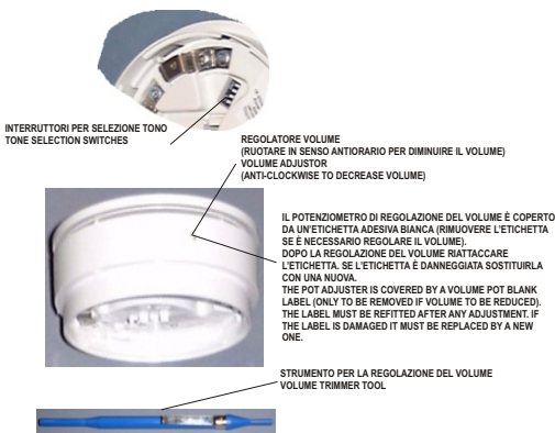
FIG.3 Base Avvisatore Acustico FC430SB FC430SB Sounder Base
