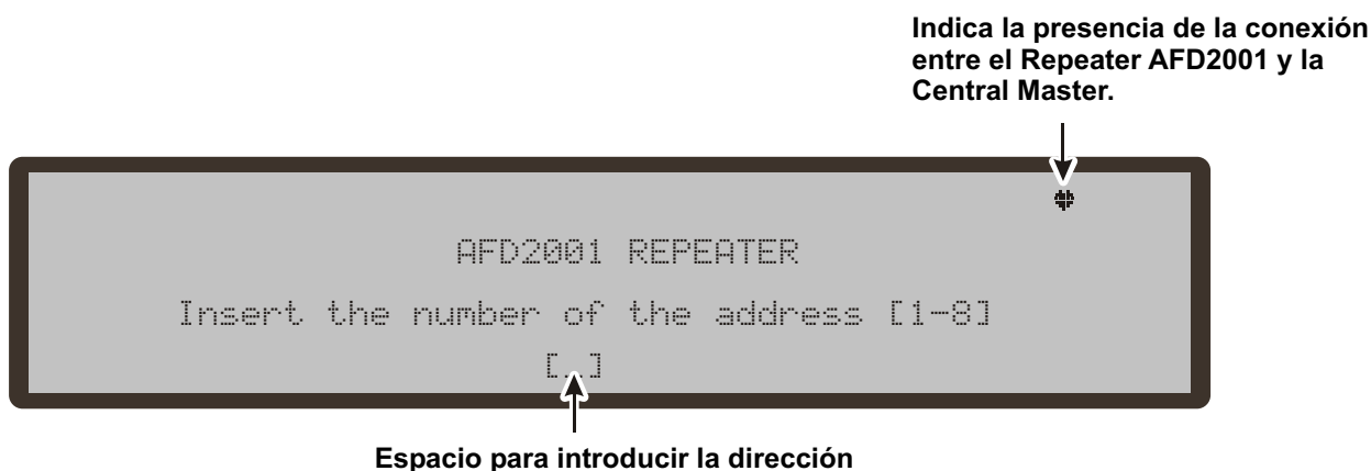
Figura 21 Pantalla para la modificación de la dirección de los Repeater AFD2001.
