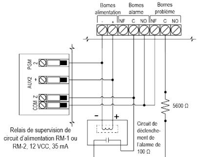
Le détecteur de fumée doit être de type enclenchement. Pour réinitialiser le détecteur de fumée, consultez le manuel d'installation de la centrale.
