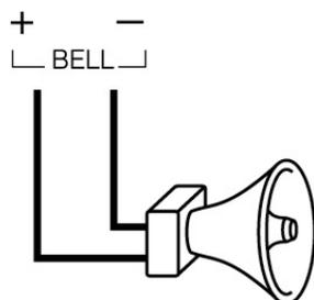
Respectez la polarité lors de la connexion des sonneries ou des sirènes polarisées.
