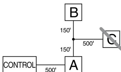
Le module (A) est correctement câblé, car il est à moins de 305 m/1000 pieds de la centrale, en longueur de câble. Le module (B) est correctement câblé, car il est à moins de 305 m/1000 pieds de la centrale, en longueur de câble. Le module (C) n'est PAS correctement câblé, car il est au-delà des 305 m/1000 pieds de câble à partir de la centrale. Pour les modèles éloignés de plus de 305 m/1 000 pieds de la centrale principale, il est possible d'utiliser une alimentation/un extenseur Corbus.
