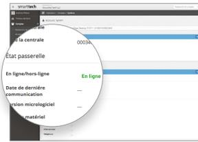
**8** Enregistrez les détecteurs (zones) et les dispositifs périphériques dans la centrale iotega en accédant à la page *Réglages de la centrale iotega*, puis sélectionnez *Ajouter un dispositif*.
