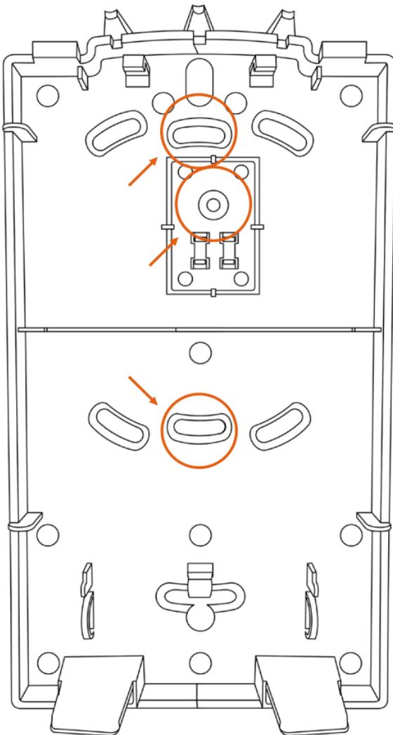
Coloque la placa posterior a un lado y perforo agujeros en los lugares de montaje.
