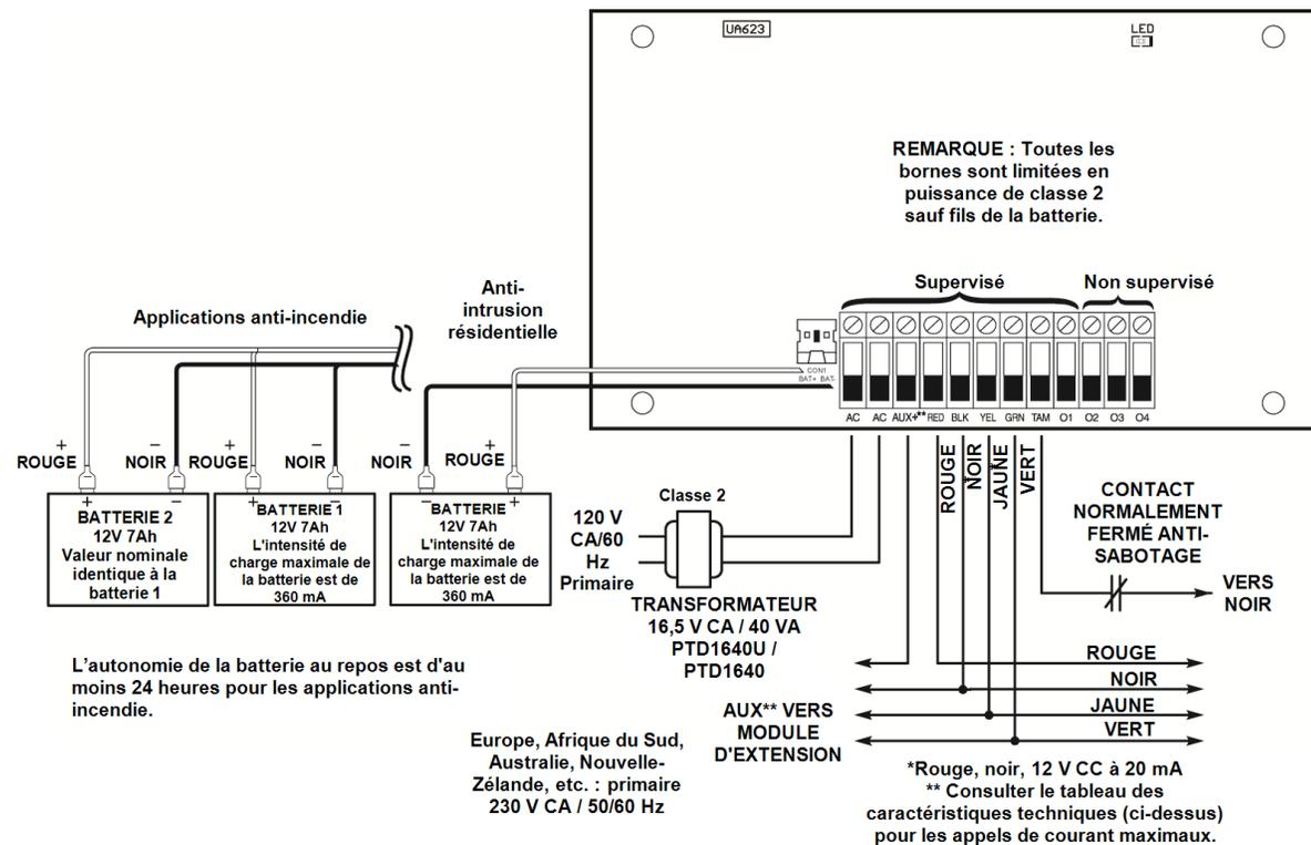
Figure 3-4 Câblage d'une alimentation électrique
