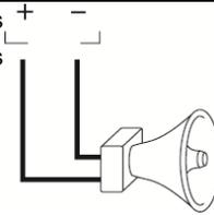
**Assurez-vous de respecter la polarité lors de la connexion des sonneries ou des sirènes polarisées**
