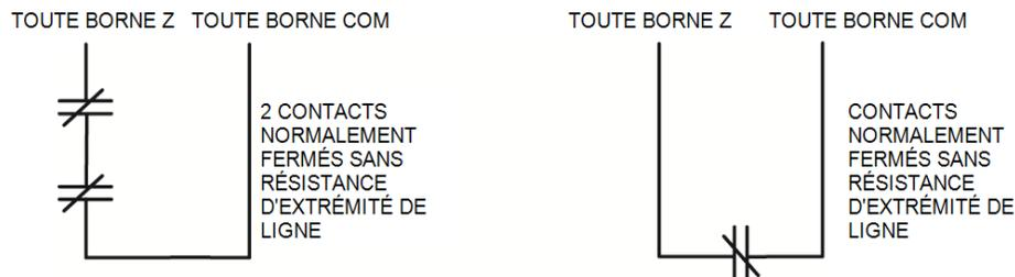
**Figure 3-6 Normalement fermé**
