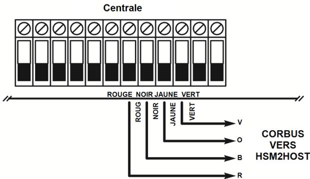
Figure 3-3 Schéma de câblage du système HSM2HOSTx
