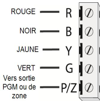
**Figure 3-5 Bornes P/Z de clavier**
