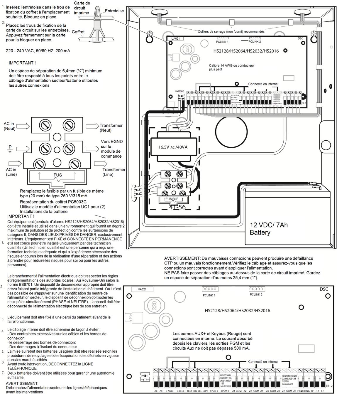
Figure 2-2 Acheminement du câblage (EN50131 uniquement)
