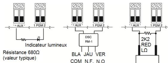
**IMPORTANT :** Un espace minimum de 6,4 mm (1/4") doit être respecté entre les circuits RM-1 et tous les autres câbles.
