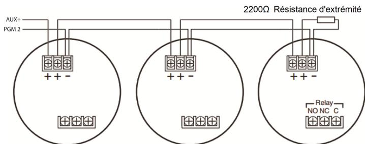
**Figure 3-13 Câblage d'un détecteur de fumée à 2 fils**
