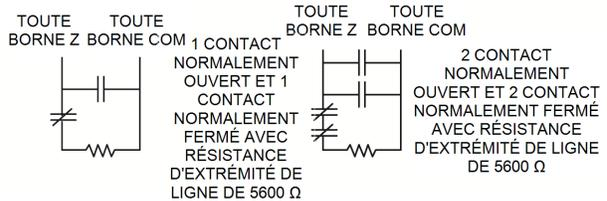
**Câblage de résistance double d'extrémité de ligne**
