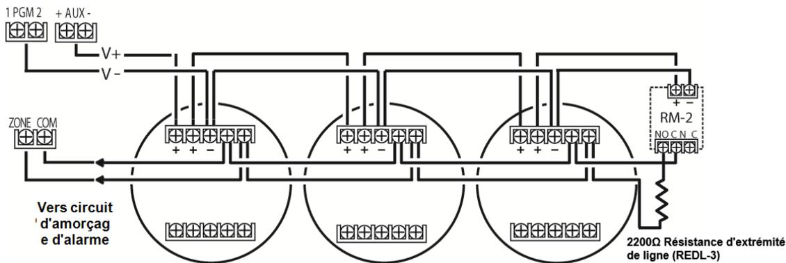
**Figure 3-12 Détecteur de fumée, Câblage**
