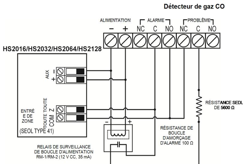
Figure 3-14 Câblage de détecteur de gaz CO
