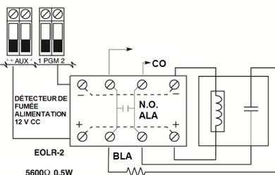
Le détecteur de fumée doit être de type à verrouillage (par ex., gamme DSC FSA 410B). Pour réinitialiser le détecteur de fumée, entrez [\*][7][2]
