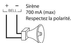
La sortie de sonnerie est surveillée et de puissance limitée par un CTP de 2A. Si un dispositif d'avertissement et d'alarme est connecté aux bornes de sonnerie, une résistance de terminaison n'est pas nécessaire. Si aucun dispositif
