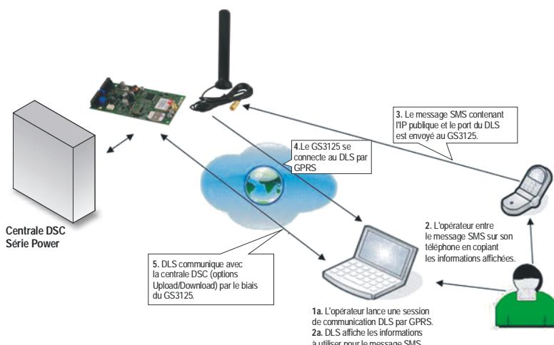
Fig.7 - Programmation à distance à l'aide du logiciel DLS IV INT.
