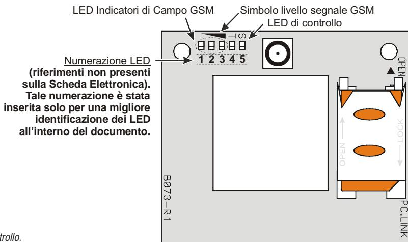
*Fig. 4 - LED di controllo.*
