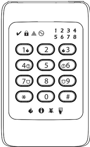
O teclado PC1404RKZ exibe o status do sistema utilizando LEDs juntamente com símbolos e números. O teclado pode ser utilizado em sistemas de segurança com até 8 zonas. O teclado PC1404RKZ é compatível com o sistema de segurança PC1404. Estas instruções devem ser utilizadas em conjunto com o Manual de Instalação do controlador de alarme PC1404.
