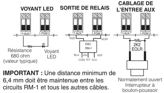
**IMPORTANT :** Une distance minimum de 6,4 mm doit être maintenue entre les circuits RM-1 et tous les autres câbles.
