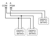
dispositivos LMD. Por favor vea las Instrucciones de Instalación provistas en cada dispositivo para obtener mayor información referente a la operación y cableado.
