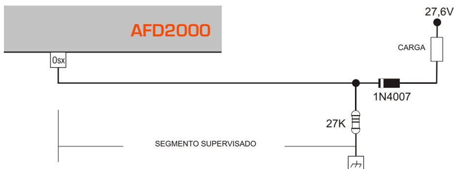
Figura 7 Esquema de Conexión Salidas
