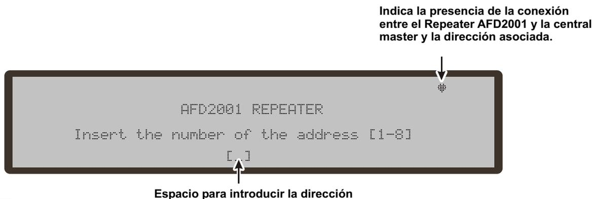
Figura 42 Pantalla para la inserción de la dirección de los Repeater AFD2001.
