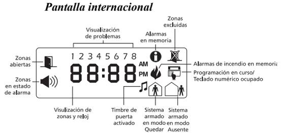
El teclado numérico RF5501-433 combina un receptor estándar PC5132 con un teclado numérico LCD5501Z que presenta el estado del sistema mediante una pantalla LCD con mensajes fijos o símbolos. Con la aportación del módulo del receptor, el panel de control ahora podrá trabajar hasta con 32 zonas. El teclado numérico RF5501-433 es compatible con los siguientes sistemas de seguridad DSC:
