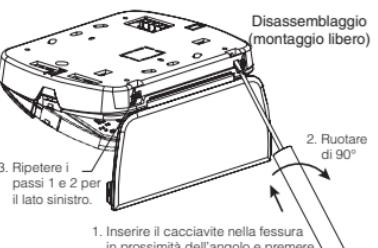
2. Rimozione della tastiera dalla piastra posteriore in seguito al montaggio. (a) Aprire il pannello e tenerlo in una posizione di 90° rispetto alla tastiera, come illustrato sotto. (b) Inserire il cacciavite nella fessura situata sotto l'area di giunzione del pannello e girare il cacciavite.
