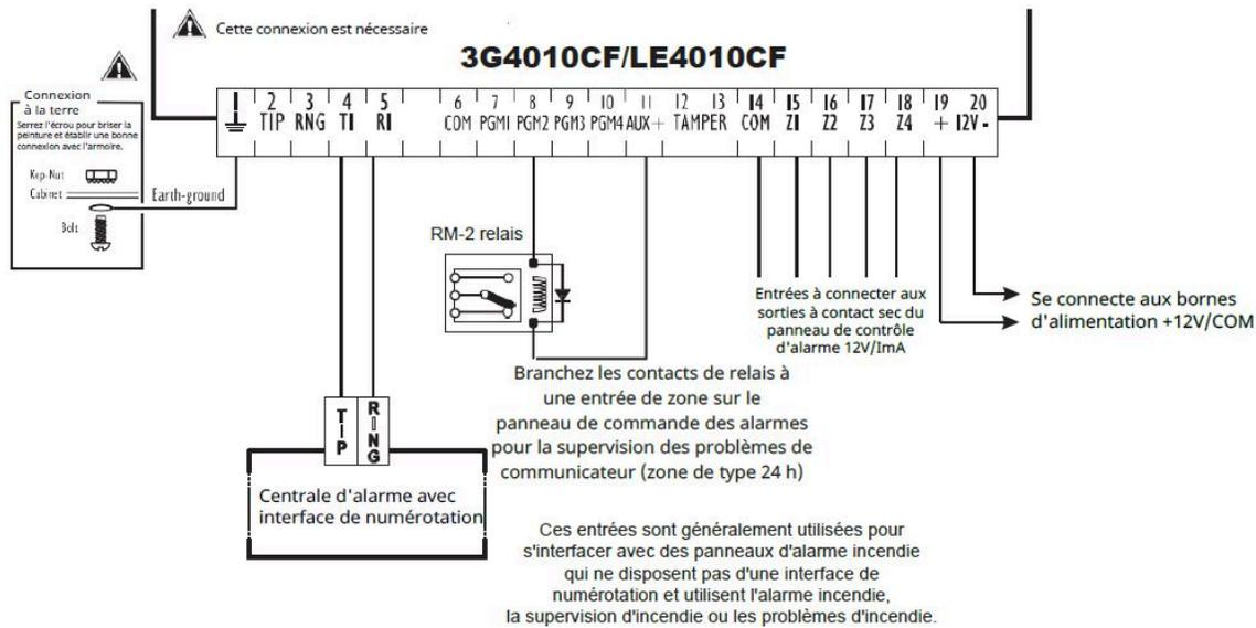
**Illustration 4 : Schéma de câblage de l'alimentation électrique**
