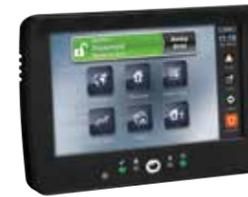
**Clavier à écran tactile prêt pour être utilisé avec des jetons de proximité (offert en noir ou en blanc (HS2TCHPRO / HS2TCHPRO(BLK))**
