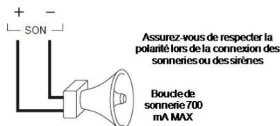
La sortie de sonnerie est supervisée et de puissance limitée par un CTP de 2A. Si elles sont inutilisées, connectez une résistance de 1000 Ω aux bornes Bell+ et Bell- pour empêcher que la centrale d'alarme signale un problème. [Dépannage](#).
